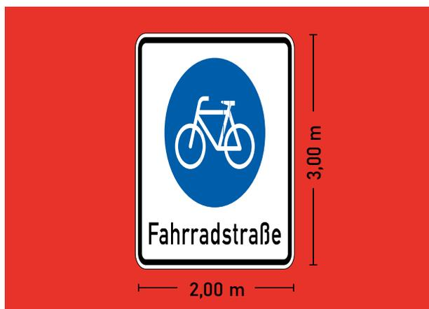
Bild 3: Prinzipskizze einer überhöhten Darstellung des Piktogramms „Beginn einer Fahrradstraße“ auf Rotmarkierung
