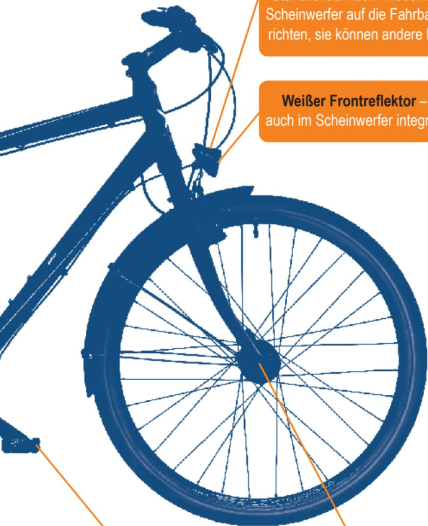
**Frontscheinwerfer** – am besten mit LED-Leuchte, Sensor- und Standlichtfunktion. Moderne LED-Scheinwerfer auf die Fahrbahn ausrichten, sie können andere blenden
